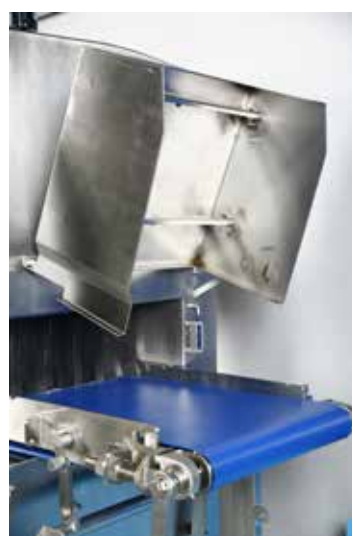
Figure 5: carter incernierati che consentono di accedere facilmente al nastro
