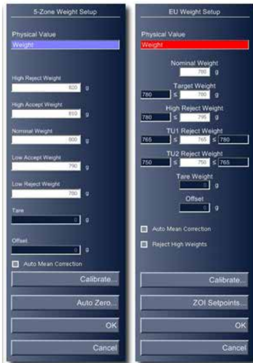
Figura 1.B: impostazione del controllo peso relativa alla zona 5 e alle zone di pesatura UE per i sistemi a raggi-X Eagle
