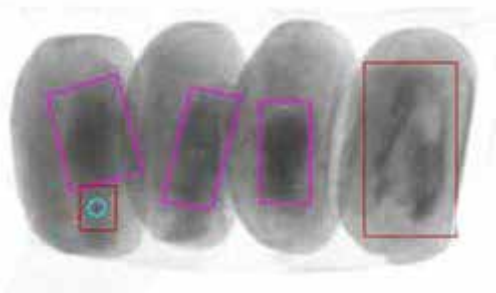
Figura 2: confezione di bomboloni di cui uno presenta un riempimento insufficiente e un altro risulta contaminato
