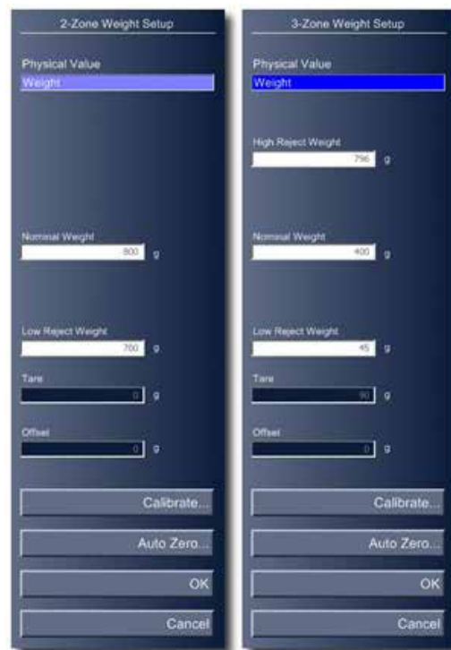
Figura 1.A: impostazione del controllo peso relativa alle zone 2 e 3 per i sistemi a raggi-X Eagle
