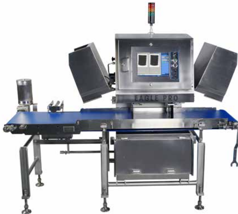
Figura 3: Pack 400 HC dispone di feritoie semplici da aprire e il campo visivo libero da ostruzioni aiuta gli operatori nelle attività di supervisione, pulizia e manutenzione.
