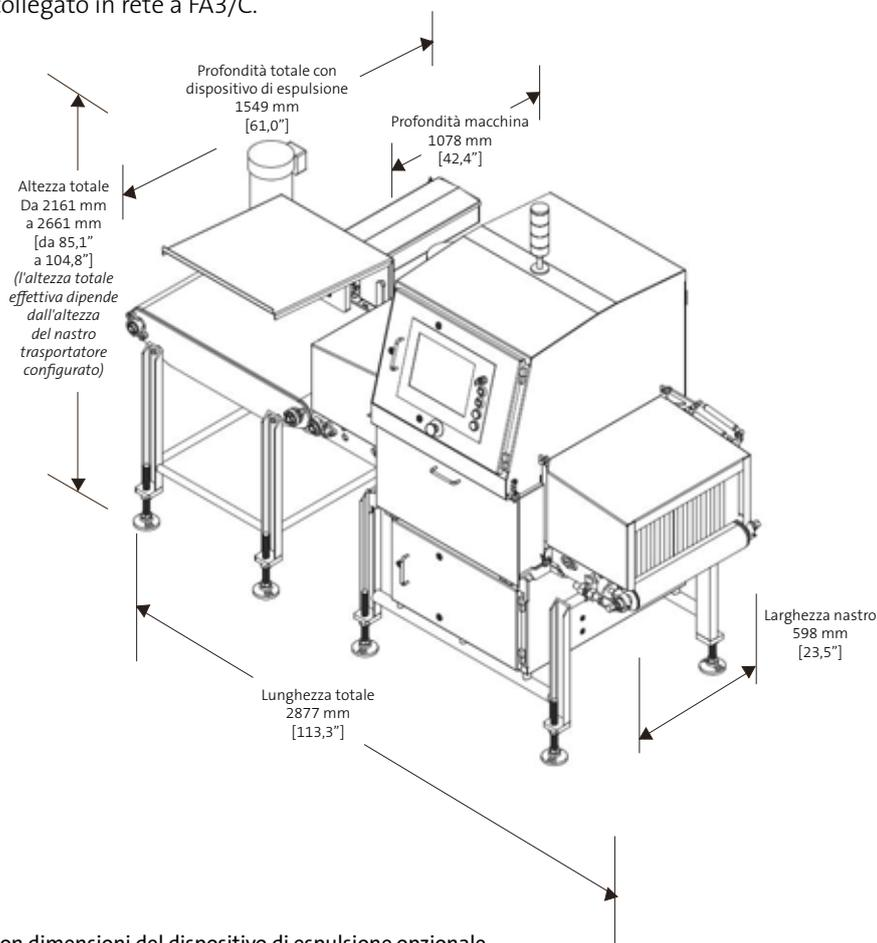
Figura 1: Eagle™ FA3/C con dimensioni del dispositivo di espulsione opzionale
